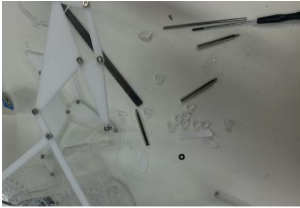
Figure 25. 간격 유지를 위해 축에 끼워 사용한 도넛모양의 아크릴
