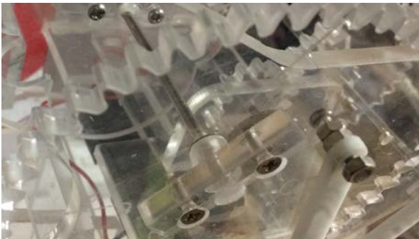
Figure 26. 간격 유지를 위해 축에 끼워 사용한 도넛모양의 아크릴
