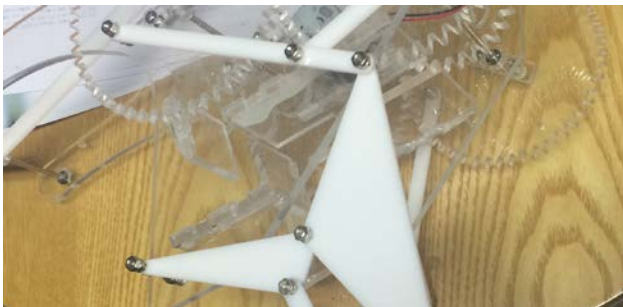
Figure 22. 링크를 이어줄 때 볼트-너트 2 개의 조합으로 공간을 두며 고정 가능
