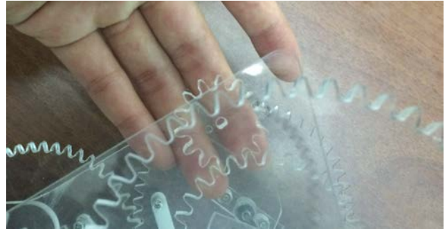
Figure 23. 축이 끼워지는 기어의 구멍이 한 쪽이 편평한 반원형이다.
