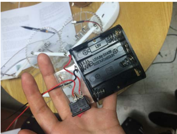
Figure 27. 모터에 전력 공급을 해줄 전지 케이스와 스위치 부품들을 조립, 축과의 고정을 강화하기 위해 순간접착제와 글루건을 사용하여 뼈대를 완성, 전지 케이스를 연결(Fig.27.)해 구동이 잘 되는 것(Fig.28.)을 확인했습니다.
