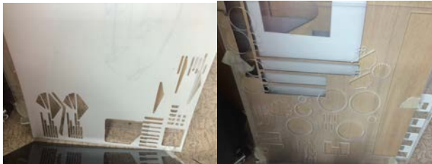
Figure 21. 아크릴 3T(좌), 5T(우) 레이저 커팅
